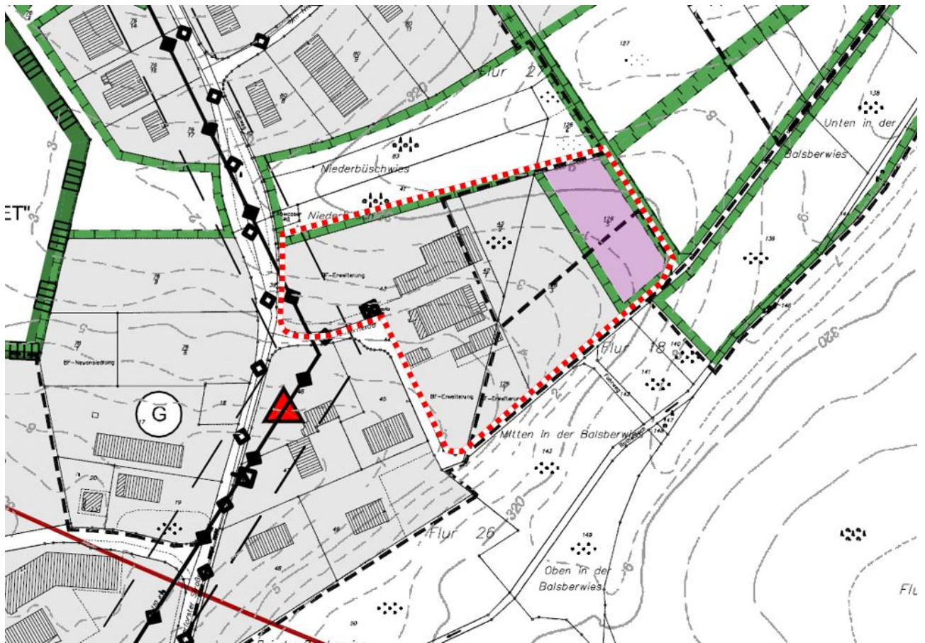
Abbildung 5: Ausschnitt aus dem wirksamen Flächennutzungsplan der VG Speicher mit Abgrenzung des Plangebiets (rot-weiß-gestrichelt) des Bebauungsplans „Gewerbegebiet Niederbüsch“ sowie der farblichen Hervorhebung (lila) des FNP-Änderungsbereichs (Quelle: Flächennutzungsplan 11.08.2005 | eigene Darstellung | ohne Maßstab)
